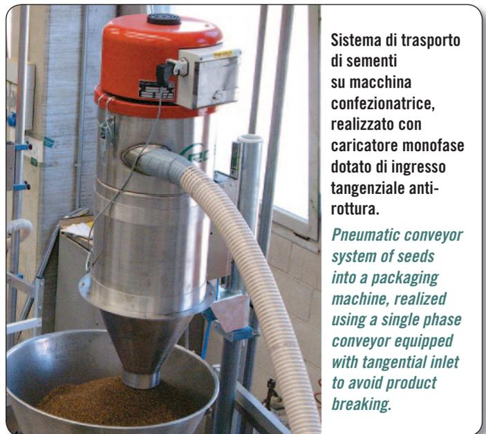
Sistema di trasporto di sementi su macchina confezionatrice, realizzato con caricatore monofase dotato di ingresso tangenziale anti-rottura.
