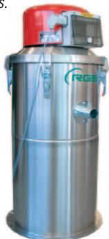
**Trasportatori alto vuoto**, ideali per il trasporto di polveri miscelate in fase densa: sfruttando un'elevata depressione e una portata d'aria molto bassa, viene mantenuta l'omogeneità del prodotto.
